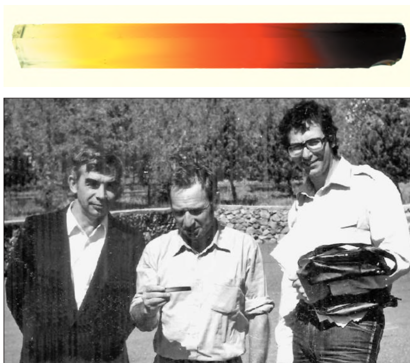
Рис.1. Полупроводниковые нанокристаллы в стекле и их исследователи. Градиентный образец со сферическими нанокристаллами \text{CdSe} (вверху), чьи диаметр и длина волны излучения меняются от 4 нм (580 нм, желтый) до 10 нм (680 нм, красный). Пионеры изучения нанокристаллов. Слева направо: Алексей Иванович Екимов, Алексей Львович Эфрос и Александр Львович Эфрос (1984 г., Армения). А.Л.Эфрос рассматривает градиентный образец с верхнего рисунка.
